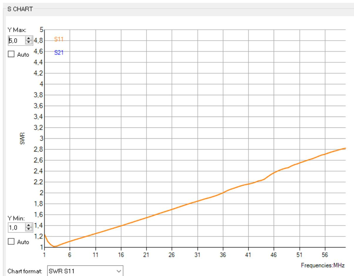
Das Messergebnis kann, durch die Länge des Koaxialkabels zwischen Balun und Antennen Analyser, abweichen.
