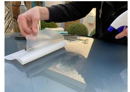
3. Die aufgelegte Folie kann jetzt nochmals auf die korrekte Position ausgerichtet werden
